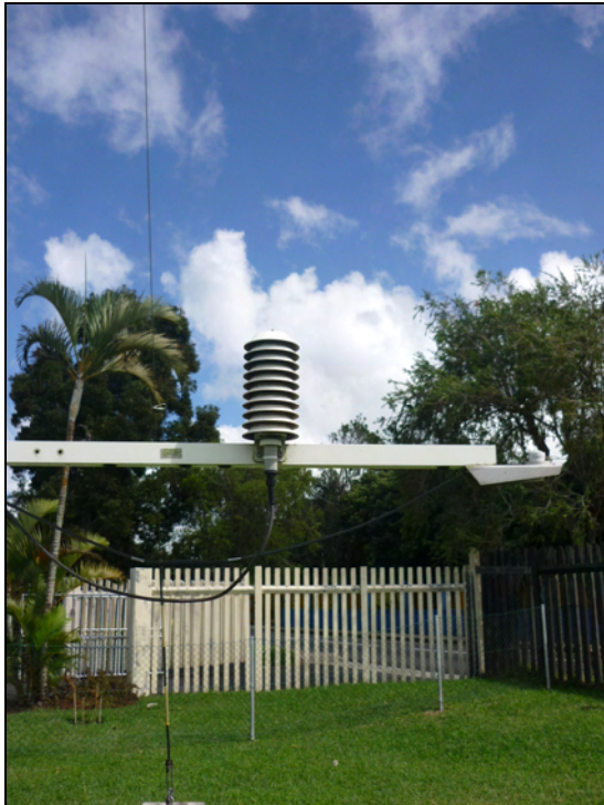
温度湿度計シェルター (Bacos) 自然通風式のシェルターに温湿度センサーが取り付けられている (日本は強制通風式)。
