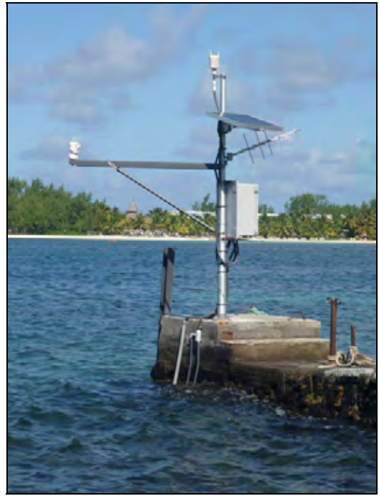
波高計 (Blue Bay) ブロック左側に海中センサーが付けられており、ポールにはデータロガーが付けられている。アンテナは衛星通信用。
