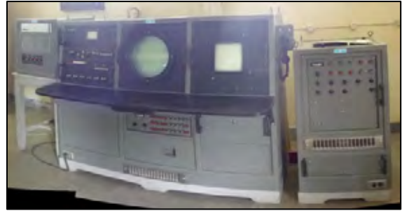
旧気象ドップラーレーダー処理部 (Trou aux Cerf) 現在は停止しているが、セキュリティが十分にされており、 機材はそのまま残っている状況である。
