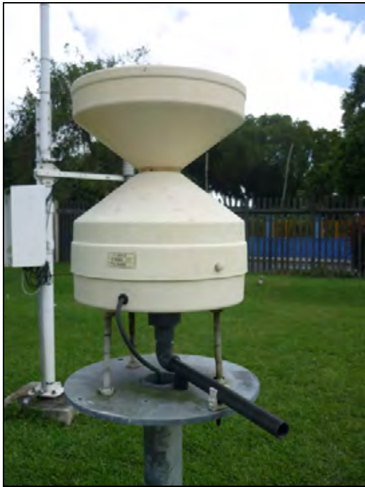
雨量計 (Bacos) 他の AWS 観測所より大型である。さらに、プラスチック製である。
