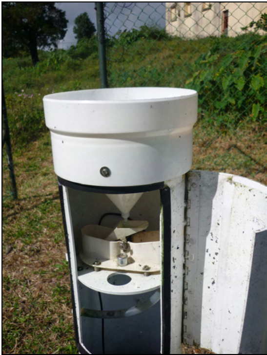
AWS 雨量計 (Mon Bois) 同雨量計の計測精度は、0.2mm 単位 (日本は、0.5mm 単位)。 雨量計感部はプラスチック。
