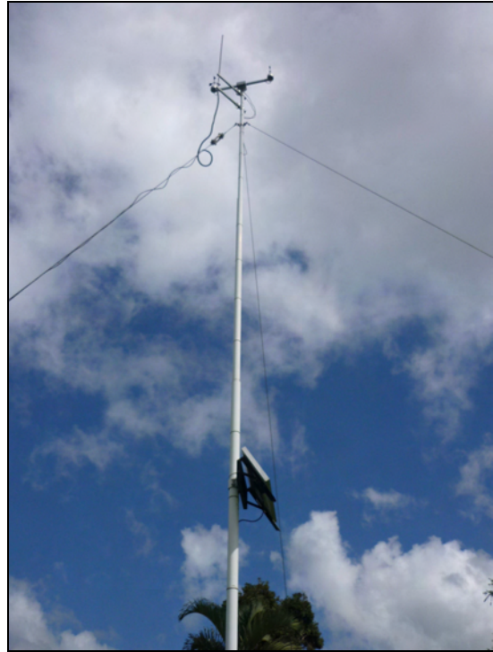
風速計 (Bacoas) 風速は三杯式であり、風向は分離型 (日本はプロペラ型)。
