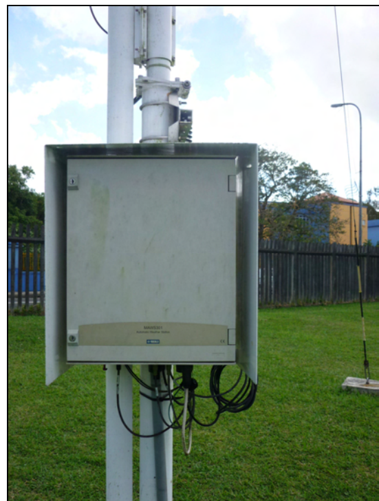
ロガーボックス (Bacos) 風速計のポール下部にロガーボックスが取り付けられている。
