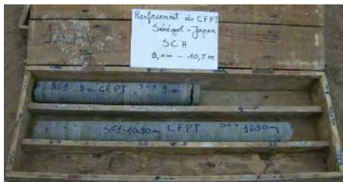
Photo 7 : Echantillons du sondage carotté A prélevés entre 9 et 10,5 m
