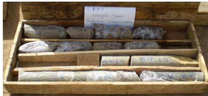
Photo 8 : Echantillons du sondage carotté B prélevés entre 7,5 et 10,5 m
