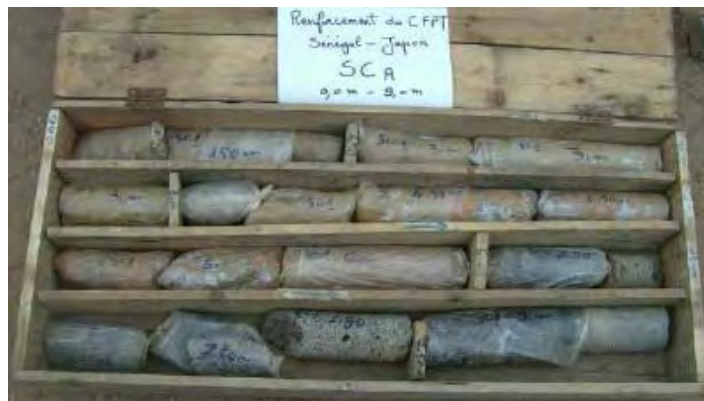
Photo 6 : Echantillons du sondage carotté A prélevés entre 0,0 et 9,0 m
