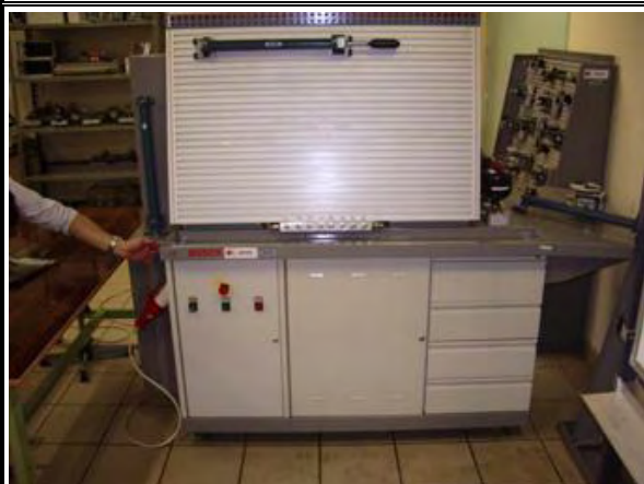
写真-8：BTS 実習棟 2階油圧・空圧実習室 油圧システム実習装置：1999年の技術協力にて 供与、状態は良好である
