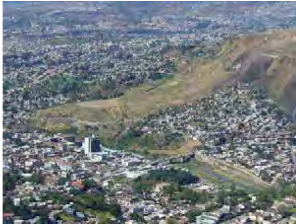
【写真-1】エル・ベリンチェ地区地すべり全景。 Cholteca川沿いにある麓の集落(左後方)を右上方から押し流し川を閉塞し、上流部地域(左側)の広い範囲を冠水させた。
