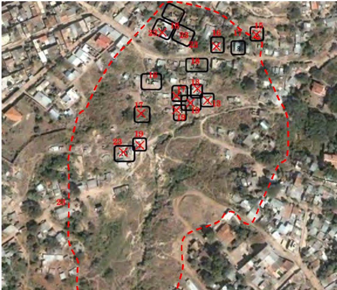
変状発生日時と破壊された家屋
