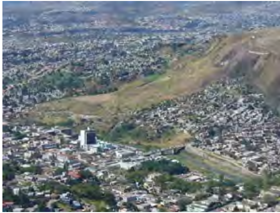
【写真-1】エル・ベリンチェ地区地すべり全景。 Cholteca川沿いにある麓の集落(左後方)を右上方から押し流し川を閉塞し、上流部地域(左側)の広い範囲を冠水させた。
