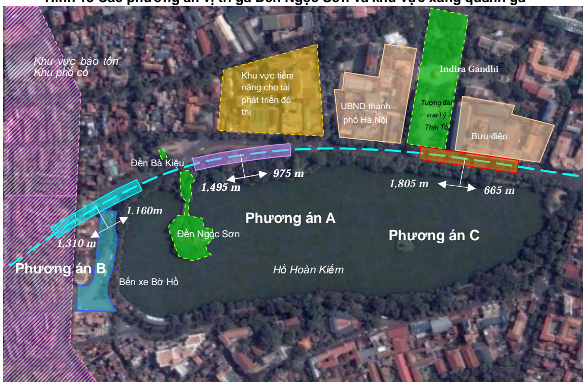
Hình 13 Các phương án vị trí ga Đền Ngọc Sơn và khu vực xung quanh ga
