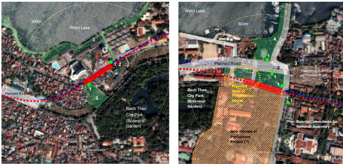
Hình 4.1.13 Kết hợp hướng tuyến của Tuyến UMRT 2 và tuyến đường bộ mới ven Hồ Tây để xác định vị trí của ga Bách Thảo (C6)
