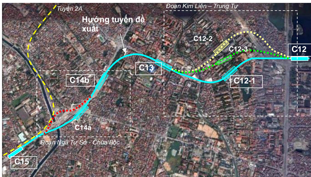
Hình 4.1.15 Các phương án hướng tuyến và Vị trí các ga trong Giai đoạn II từ ga Cầu Dền (C11) đến ga Thượng Đình (C15) trong Nghiên cứu Khả thi (TEDI South)
