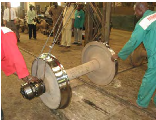
天井クレーンで運搬中の修理を終えた 車輪
