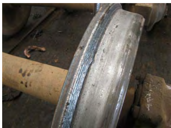
● 摩耗したフランジ部の盛金をした車輪 旋盤で削って完成となる。
