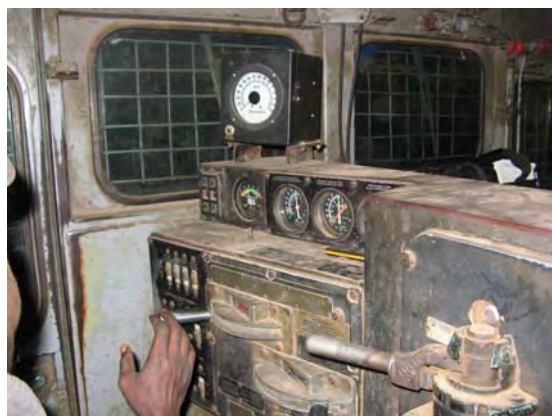
● 機関車運転席の計器：速度計動作せず
