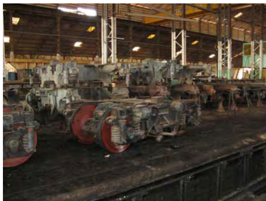
修理中の機関車の台車
