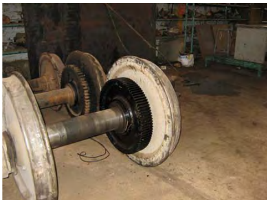
● 異常な形に摩耗した機関車の車輪
