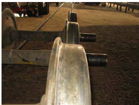
車輪フランジ部の異常摩耗
