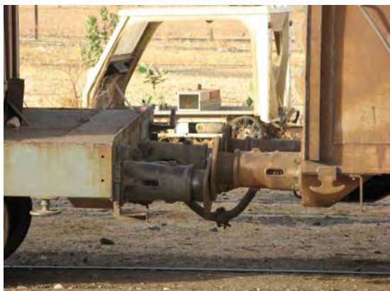
● リンク式連結器：バッファー高さの不揃
