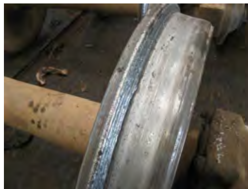
摩耗したフランジ部の盛金を車輪旋盤で削る
