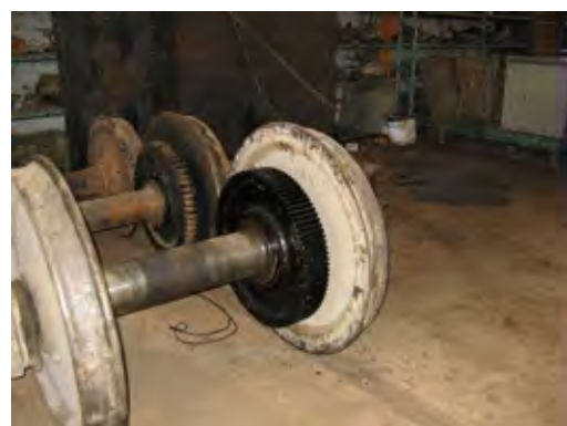
異常な形に摩耗した機関車の車輪
