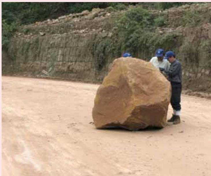
Examen des blocs d'éboulement (taille, scénario d'éboulement, dégâts)
