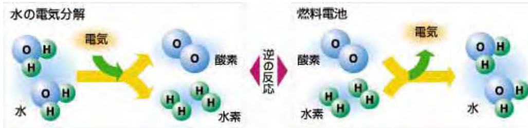
図 3.4.9 燃料電池の発電原理
