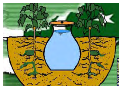
Irrigação por Cápsulas Porosas
