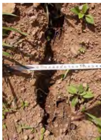
Danos Provocados pela Erosão em Sulcos (A parte superior da foto corresponde à de montante do talude.)
