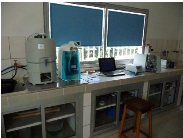
コルビゾンのラボの既存分析機器。写真右に見えるイオンクロマトグラフは3年間使用されているが、維持管理状況は良好である。本プロジェクトにおいても1台調達することが計画されている。
