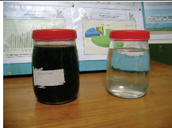
写真 3-2 ビゼルト最終処分場の浸出水
