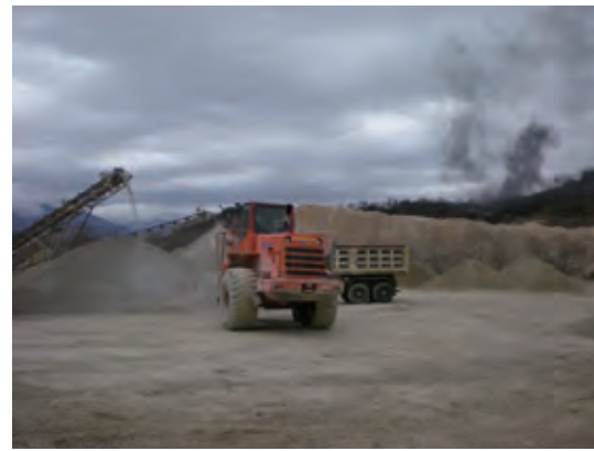
写真 5.6.6 クラッシャー・プラント における石灰石破碎物の分級作業
