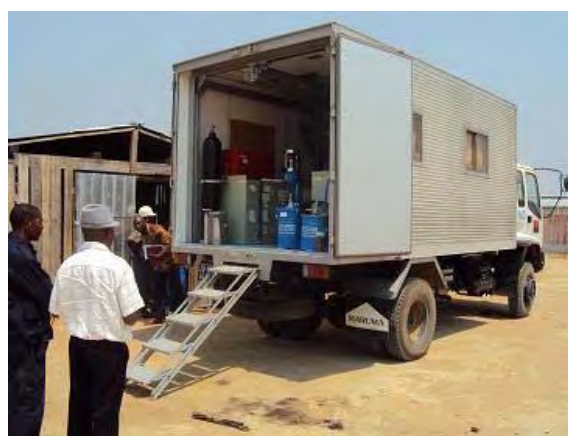
<溶接器等を搭載したモバイル・ワークショップ>
