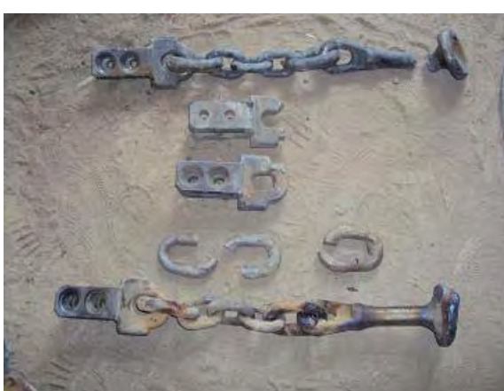
<破損部品と修理後のチェーン>
