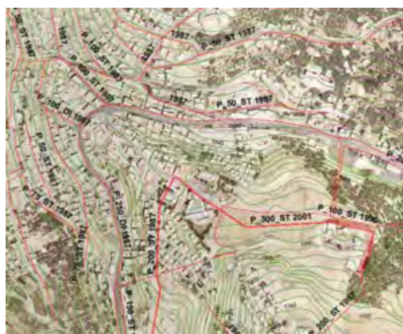
タフィーラ市の急斜面に広がる市街地と既存配管路線 (衛星写真：等高線は5m 間隔)
