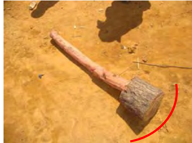
Donner une forme convexe à la base de la dame à main.
