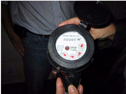
盗難防止のために購入した硬化プラスチック製の給水メーター（韓国製）
