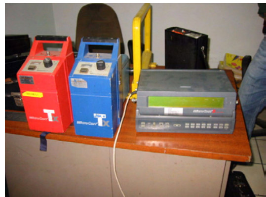
相関式漏水探知器
