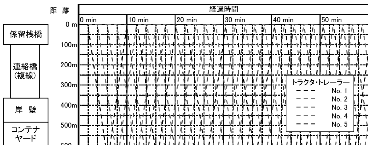
図 3.2.2-13(a) トラクタ・トレーラーの運行ダイヤグラム（連絡橋：複線、トレーラー：5 台）
