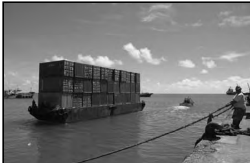
写真-11 バージの曳航状況 (空コン)
