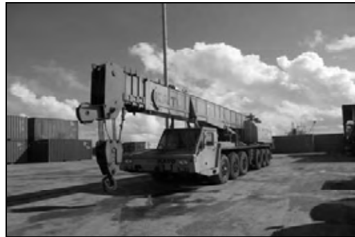
写真-15 80 トン吊りクレーン
