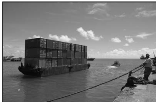
写真-11 バージの曳航状況 (空コン)
