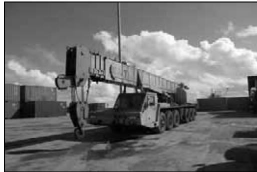
写真-15 80 トン吊りクレーン
