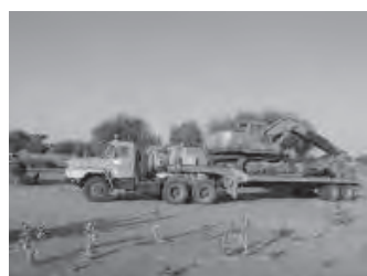
トレーラー、バックホー
