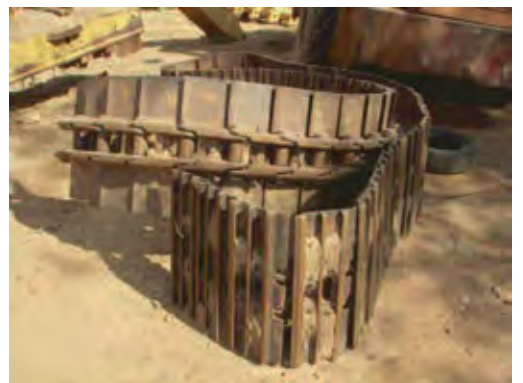
シリンダーの片減りにより 廃棄されたキャタピラー
