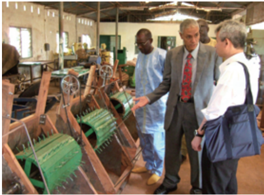
写真5 NARI エンジニアリング部にあるマニュアルタイプの脱穀機。年間に 40 台ほど生産している。
