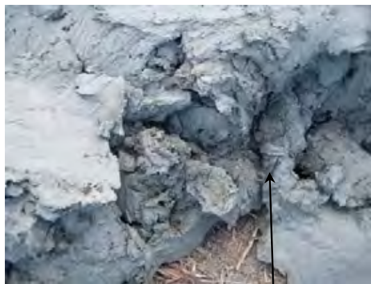
Ph-6 粘土～セメント混合後、撤き出された状態（収容ビン内混合、Case1-1(10/26)）よく練り混ぜられたことを反映した様相を呈するが、 部分的には粘土の中に取り込まれていないセメント粒子もある。
