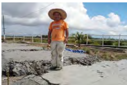
Ph-7 1日経過後の Case1-1 撒きだし層の支持力(10/27)：他の撒きだし層では不可であるが、本層では上に乗れた。支持力 \geq 75\text{kg}/(30\text{cm}\times 10\text{cm})=0.25\text{kg}/\text{cm}^2
