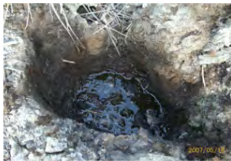
注水後の観測孔の状況
