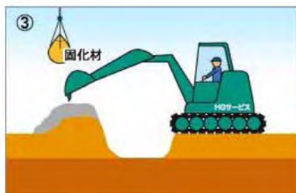
③ 固化材と現地土をよく混ぜます。
