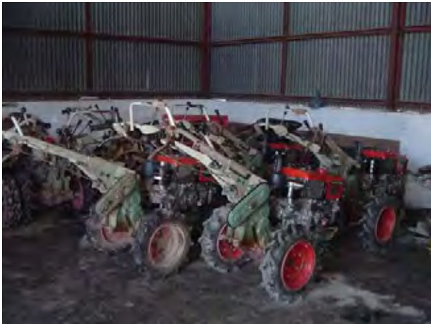
フェーズ1で供与されたハンドトラクターは、WUAの賃耕サービス（圃場準備請負）に活用されているが、13台中2台は故障している。
