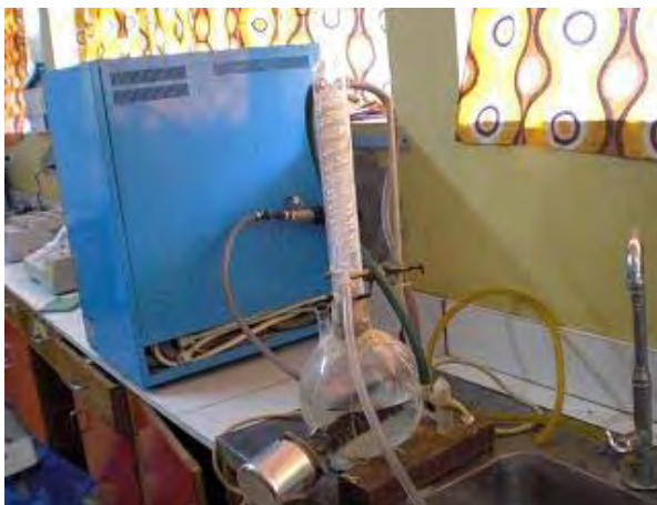
蒸留水製造装置: 市水は硬度分が多いため、硬度分のほとんどない雨水を利用している。直近に雨どいから取水する雨水タンクがある。
