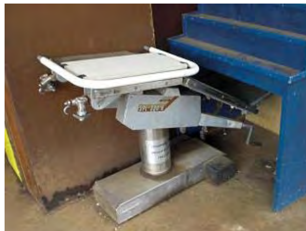
手術台(わが国協力): 故障して病棟の外に放置された手術台。記録がないのでいつ故障したかが分からない。
