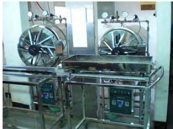
高圧蒸気滅菌器: 3台のうち1台が正常に稼働しており、他の2台は不具合が多い。いずれも消耗が著しい。
