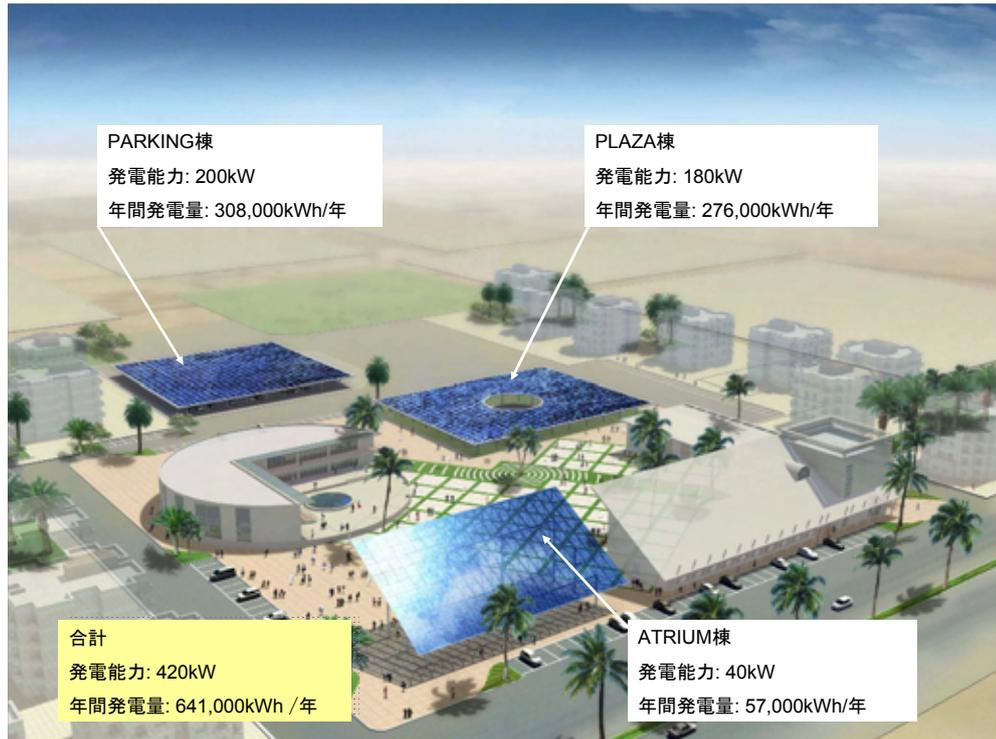
太陽光発電システム設置イメージ図
