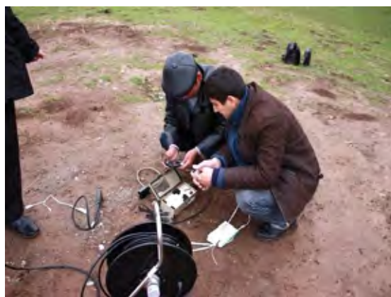
Фото4 : Сбор данных скважинного инклинометра узбекской стороной
