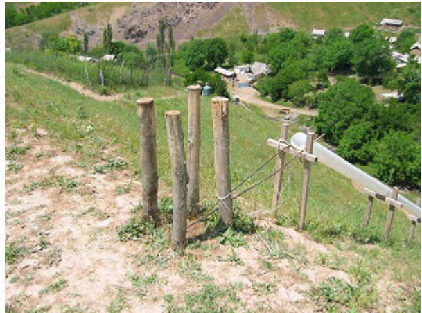
Экстензометр на участке Бедренгет Сорвана верхняя часть экстензометра. Прибор брошем поблизости
