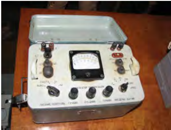
写真 5：旧ソ連製のアナログ電気探査機
