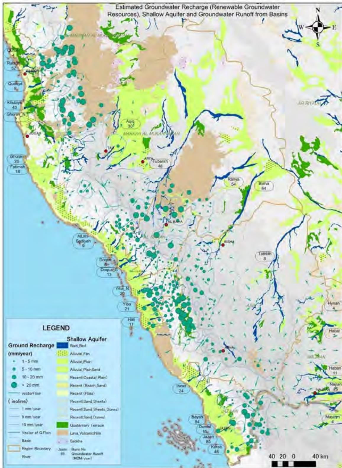
注：ワジ堆積物：青色、沖積層：黄緑、洪積層：緑、玄武岩等：褐色、および地下水涵養量（緑丸）は垂直涵養のみを示す。
