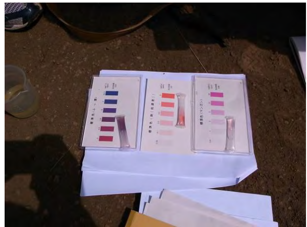
Chebilat 村 (河川水の簡易水質試験)
