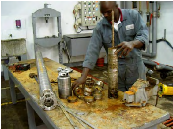
給水関連機材の民間業者 (Davis & Shirtliff 社) 水中ポンプを分解し、修理をしている。
