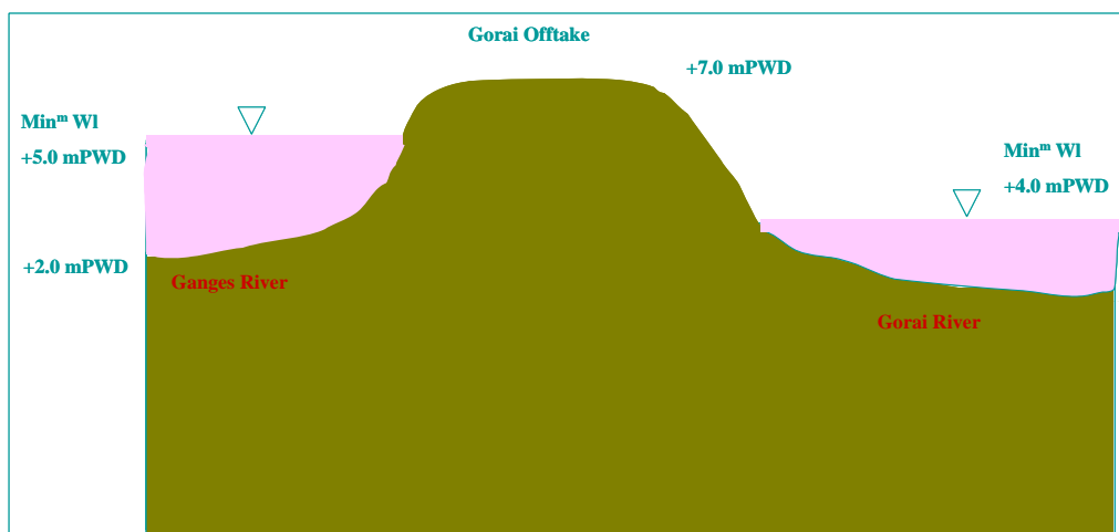
図 3.2.2 ゴライ川分流点の堆砂のイメージ
