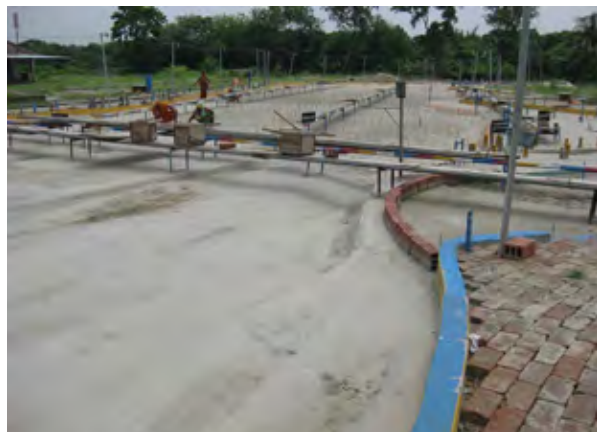
17. ガンジス堰模型実験 Barrageの全体模型 (上流から)
