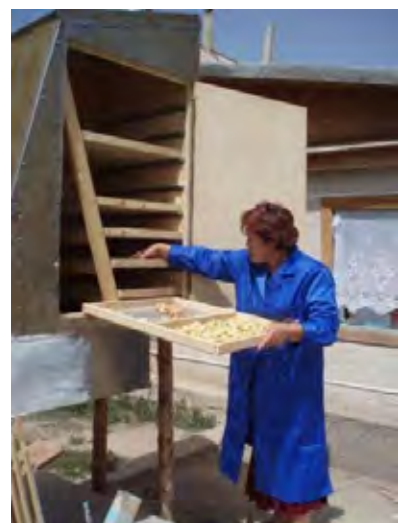
Сушка яблок на солнечной сушилке в ООС «Ширин»
