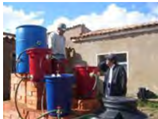
生物的緩速ろ過装置
