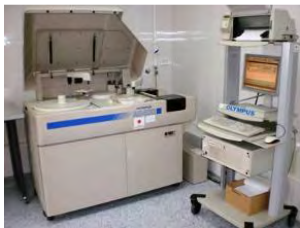
CC-Serbia 自動生化学分析装置 継続的に試薬の調達が行われている
