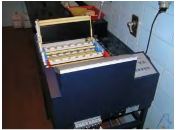
HC-10 Health Centre Kladovo 老朽化した自動フィルム現像機
