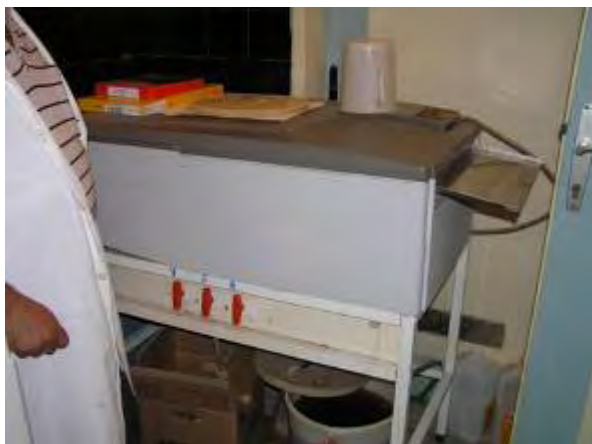
HC-08 Health Centre Negotin 老朽化した自動フィルム現像機、更新が必要
