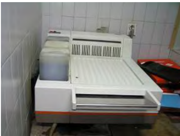
HC-11 Health Centre Knjazevac 自動フィルム現像機 小型でありマンモ用フィルムの現像には適さない
