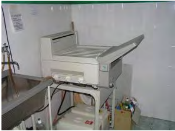
HC-02 Health Centre Senta 自動フィルム現像機 小型でありマンモ用フィルムの現像には適さない
