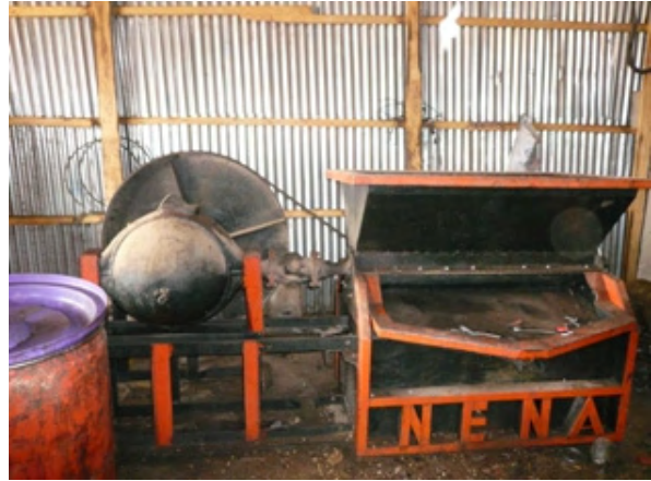
写真-1,2： 搾油に関するクラスターで、約200社（Oil mill and Plastic Clusterの会員）ある。州政府の斡旋で53社の工場が集まり、電力供給などの恩恵を受けている。原料（主にピーナッツ）は6割以上南部の他州から入っている。搾油前に、原料（ピーナッツとピーナッツ殻）の均一を図るために現地製の攪拌機を用いる。
