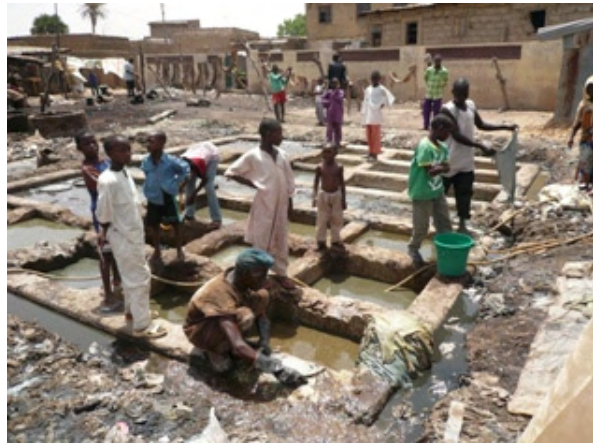
写真－9, 10： 肉皮側のたんぱく質を含む部分をそぎ落とし、水付けや石灰によって毛など不要部分を更に取り除く。オープンスペースであるが、場内の清掃が悪く悪臭が立ち込めていた。町の中心地での事業継続は難しいと思われる。
