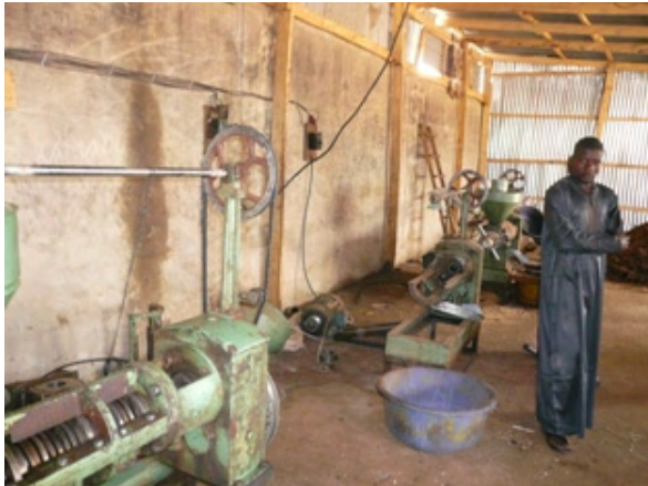
写真-3,4： 中国製の搾油機を用いている。通電時間の短さが悩みの種である。搾油後の残渣は、家畜の飼料として販売しており、効率のよい事業のひとつである。
