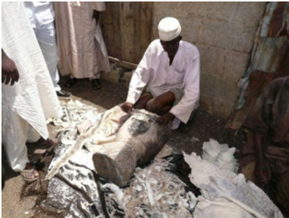
写真－9, 10： 肉皮側のたんぱく質を含む部分をそぎ落とし、水付けや石灰によって毛など不要部分を更に取り除く。オープンスペースであるが、場内の清掃が悪く悪臭が立ち込めていた。町の中心地での事業継続は難しいと思われる。
