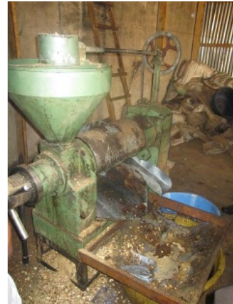
写真-3,4： 中国製の搾油機を用いている。通電時間の短さが悩みの種である。搾油後の残渣は、家畜の飼料として販売しており、効率のよい事業のひとつである。
