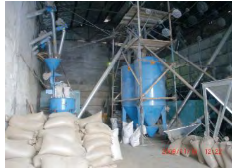
【写真4】大規模家畜生産者の中には、大型飼料配合機械を導入して、自家配合を行っているところもある(2009年11月18日:ヤコール地区)。
