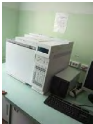
【写真 20】衛生及び疫学検査センターの残留農薬分析用ガスクロマトグラフ（2009年11月6日：ペトロパブロフスク）。
