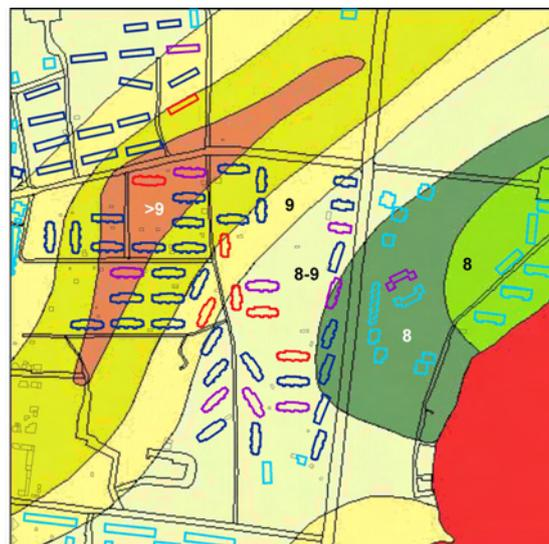
図 2-7-5 Achapnyak 区の集合住宅の被害程度の計算例（赤いほど被害大）
