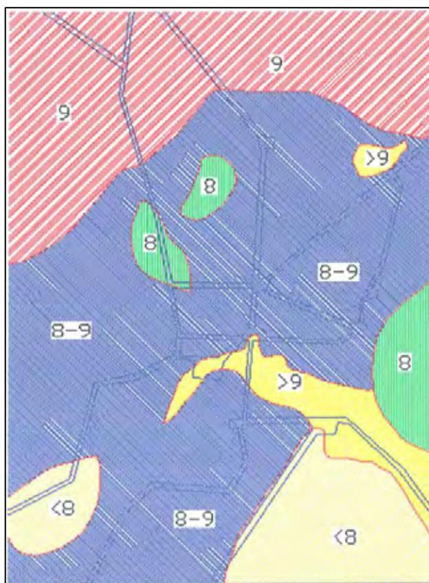
図 2-3-3 1988 年スピタク地震の Leninakan 市の MSK 震度分布 (NorSSP による)
