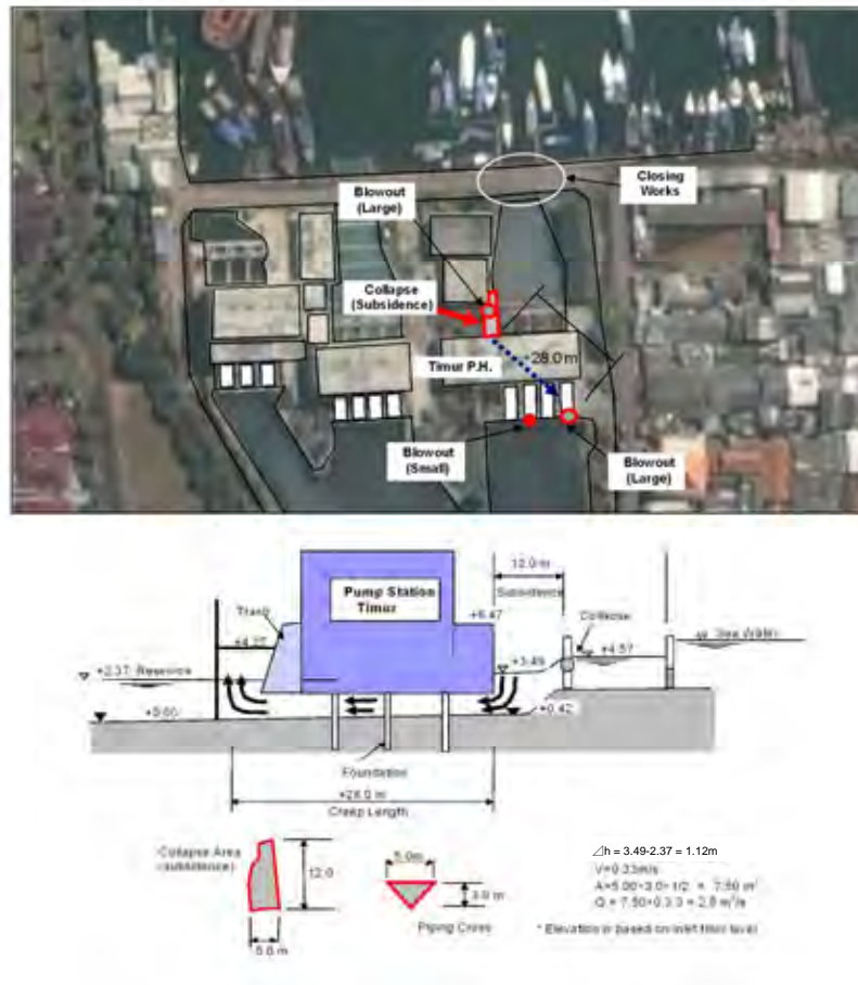
図 3-10 パイピング状況
