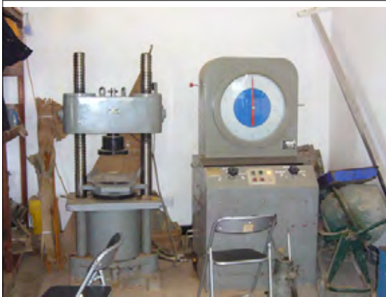
コンクリートの圧縮試験機。コントラクターが日本から持ち込んだもの
