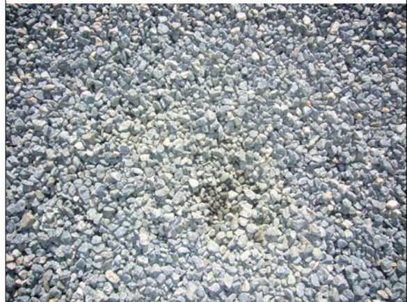
中央の白い部分が DUST が付いた砕石。回りは雨で DUST が流されている。
