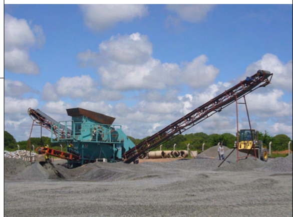
砕石からの DUST 取り。ブルドーザーで投入し、振動で DUST を落とす。
