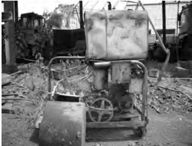
破損した高圧洗車機
