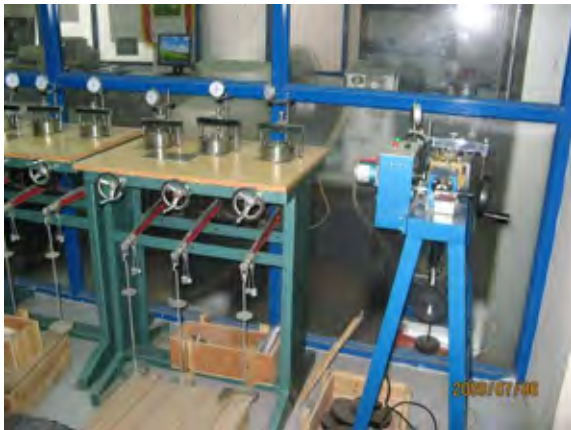
CONICO の試験室 (土の圧密試験機と直接せん断試験機)
