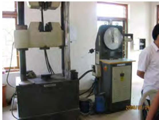
KCX の試験室 (圧縮試験機)
