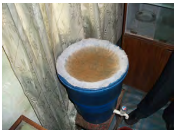
【ムラドナガール郡 DPHE 事務所にある砒素除去装置】ろ材は交換されていない。
