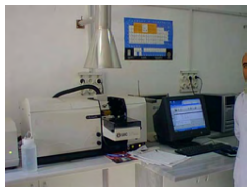
SWEIDA: 水質試験室 (原子吸光分析装置)
