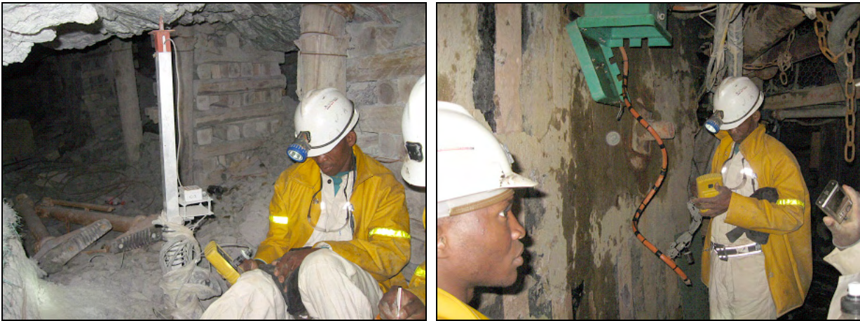
図 2-2-6 鉱山会社による変位置測定状況（エズルウィニ（Ezulwini）鉱山の例） （左：Stope（採掘箇所）での垂直変位、右：Shaft（エレベーター）での水平変位）
