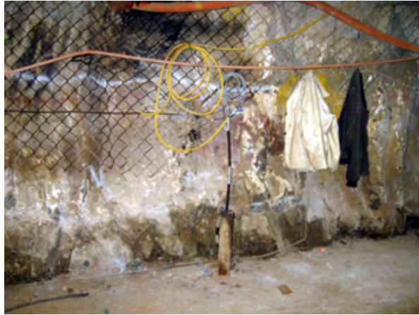
写真 20 【Ezulwini 鉱山】 Geophone（地震センサー）による観測状況
