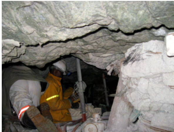
写真 22 【Ezulwini 鉱山】 Stope（採掘現場）での変位量観測状況
